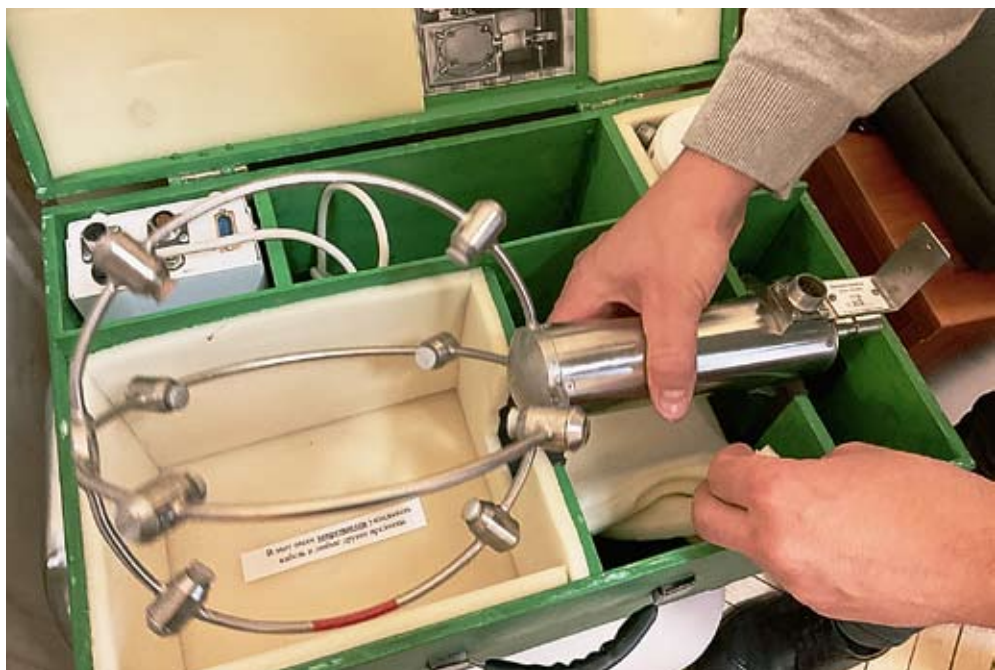
Акустический метеорологический комплекс «МЕТЕО-2» для исследования уровня турбулентности. Сделан в Институте оптики атмосферы СО РАН.
