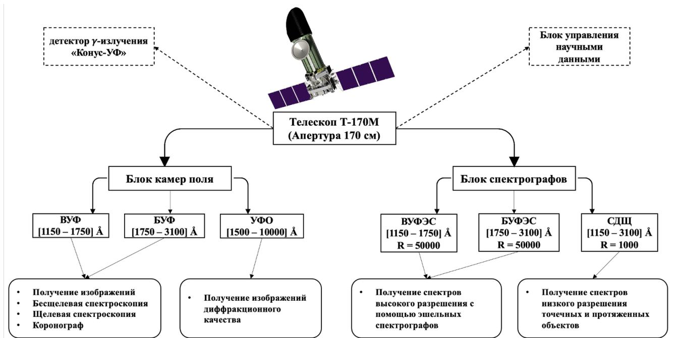
Рисунок 3.1 — Структура комплекса научной аппаратуры космической обсерватории «Спектр-УФ»
