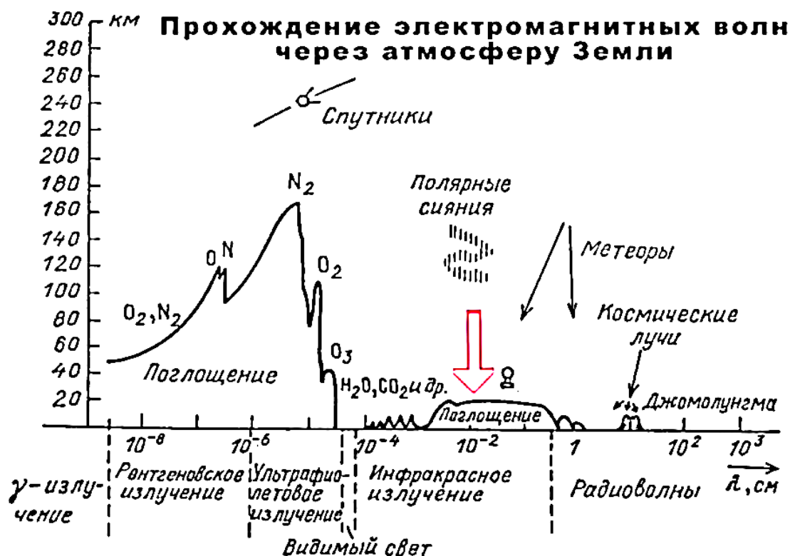
Рис. 4.6. Прохождение электромагнитного излучения через земную атмосферу. По ординате отложена высота в атмосфере, до которой проникает космическое излучение в данной области спектра.
