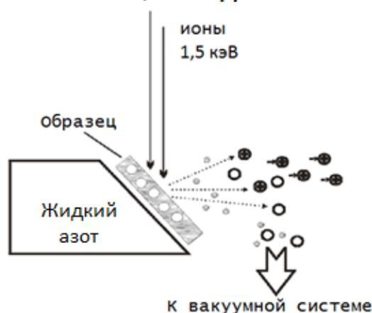
Рис. 4.1. Схема бомбардировки поверхности образца ионами.
