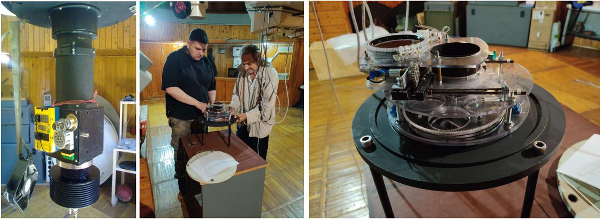
Рис. 1: Слева на право: предыдущий вариант поляриметра; монтаж прибора на посадочный фланец; прибор готовый для установки на телескоп.
