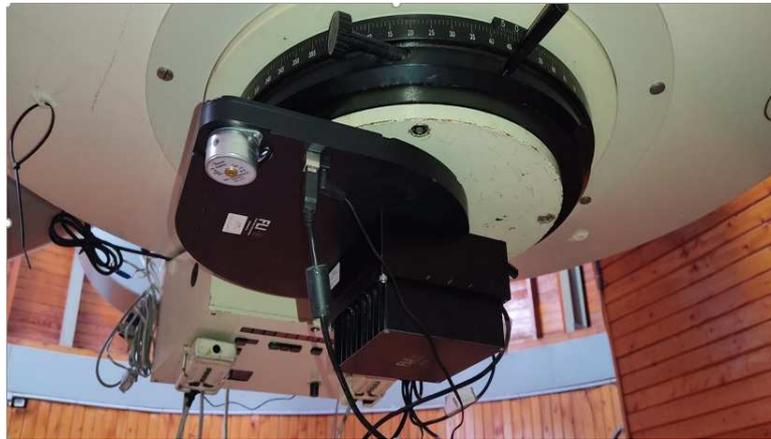
Рис. 2: Установленный прибор с камерой и турелью.
