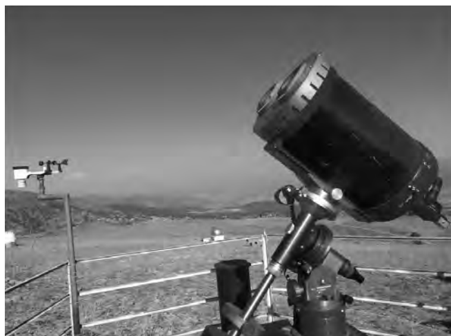
Рис. 1: Модуль DIMM — измеритель дифференциальных дрожаний звезд, установленный на платформе на высоте 6 метров над уровнем земли.
