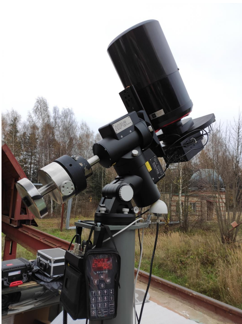
Рисунок – Фотография основного инструмента роботизированной обсерватории 20-см робот-телескопа, созданного на основе широкоугольного телескопа Officina Stellare RH-200. Робот-телескоп показан в полной сборке - на колонне, с экваториальной монтировкой и навесным оборудованием (фокусер, колесо фильтров, светоприемная ПЗС-камера).
