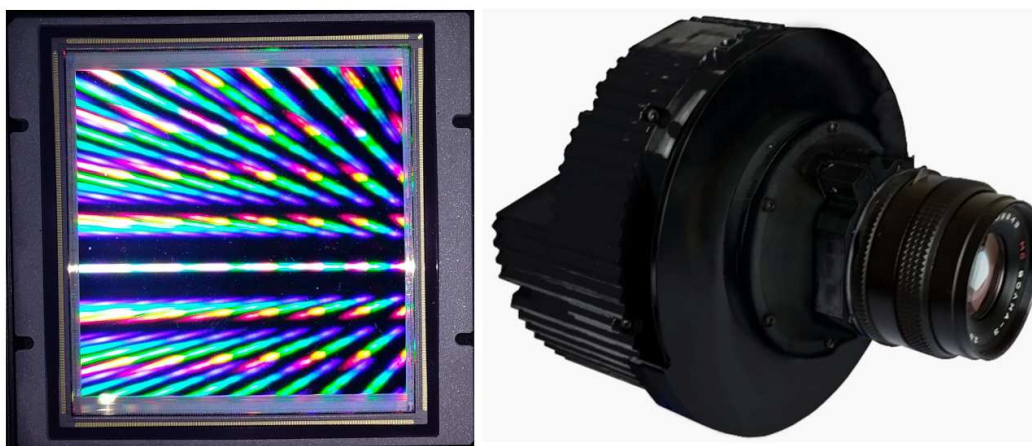
Рис. 7: КМОП GSENSE6060 (слева) фирмы GPIXEL, камера «Нева6060» фирмы «Нева Электроника» с пельтье охлаждением (справа) [9].
