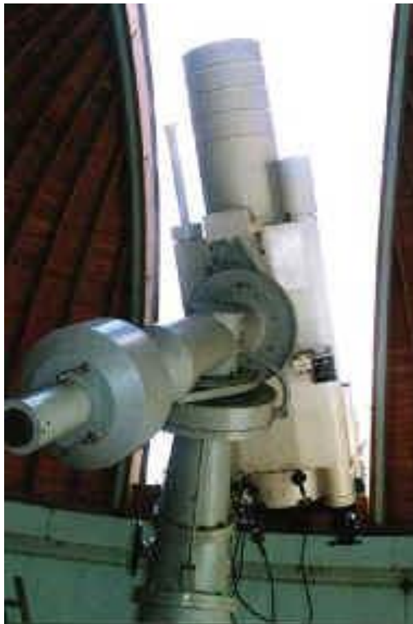
Рис. 2. Астрограф Цейс-400 Звенигородской обсерватории. Диаметр объектива = 40 см. Фокусное расстояние = 203 см.
