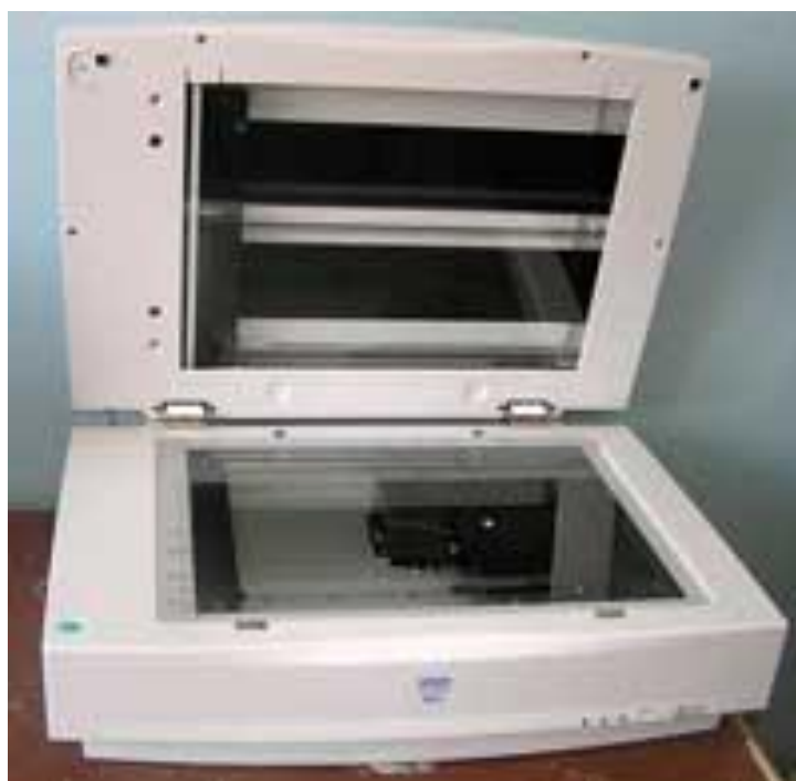
Рис. 3. Сканер Epson Expression 1640XL. Оптическое разрешение 1600 dpi. Максимальное 6400 dpi. 1 пиксель = 16 микрон. Интерполированное разрешение 12880×12880. Оптическая плотность 3.6 D.
