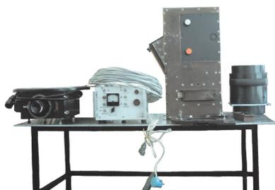
Рис. 4: Общий вид основных блоков спектрографа ММКС. Слева направо: целевая часть, электронный блок питания и управления, блок коллиматорных зеркал и дифракционных решеток, оптическая камера системы Шмидт-Кассегрен с  $F = 150$  мм (или линзовый объектив с  $F = 180$  мм).
