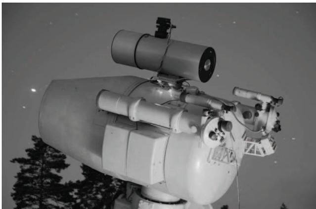
Рис. 1: Камера ВАУ Звенигородской обсерватории с установленным телескопом Сантел-500 при проведении наблюдений.
