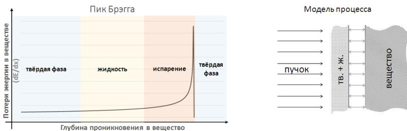
Рис. 2: Иллюстрация, поясняющая суть эффекта пика Брэгга (слева) и общая схема взаимодействия пучка с веществом мишени (справа).
