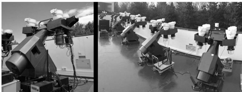
Рис. 2: Мультиапертурный телескоп GWAC в обсерватории Xinglong (Китай), установлено 16 телескопов на четырех монтировках
