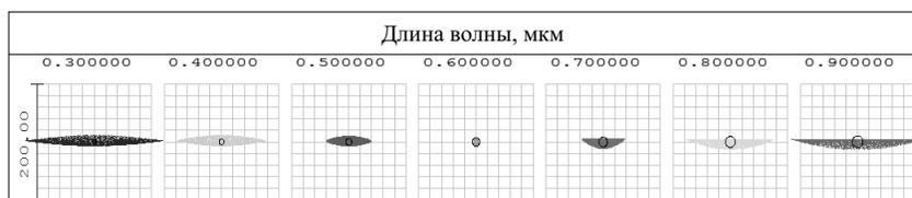
Рис. 2: Матрица диаграмм пятна рассеяния на оптической оси спектрографа UVEX. Единицы измерения в мкм, радиус кружка Эйри 6.7 мкм.
