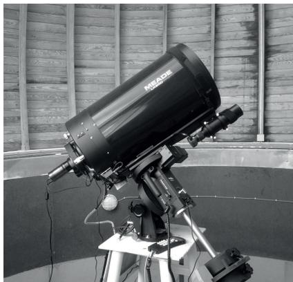
Рис. 1: Общий вид робота-телескопа IRT-35.
