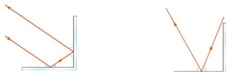
Отражение луча угольным отражателем при разных углах падения луча
