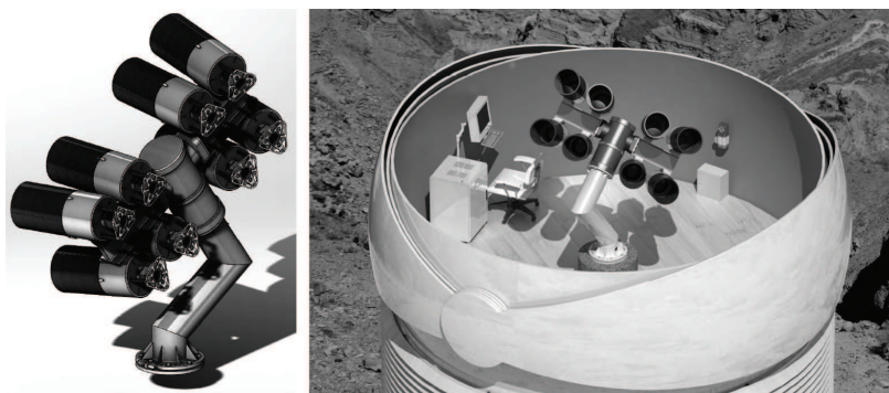
Рис. 2. Компоновка обзорного телескопа INF.
