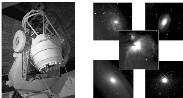
Рис. 2. Телескоп АЗТ-33ВМ и первые полученные на нем изображения астрономических объектов.
