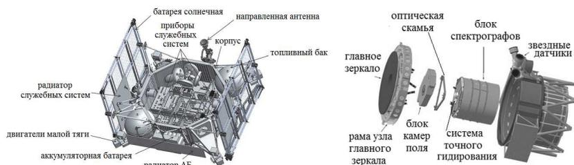
Рис. 3. Базовый модуль «Навигатор» (слева) и блок научной аппаратуры (справа).
