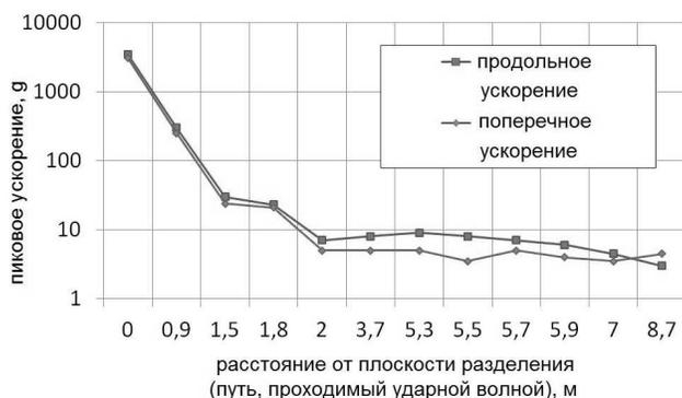
Рис. 2. Ускорения отклика при срабатывании системы отделения КА.
